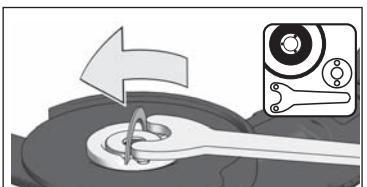
Bei feststehender FIXTEC Mutter ZweiLochmutterschlüssel verwenden.
